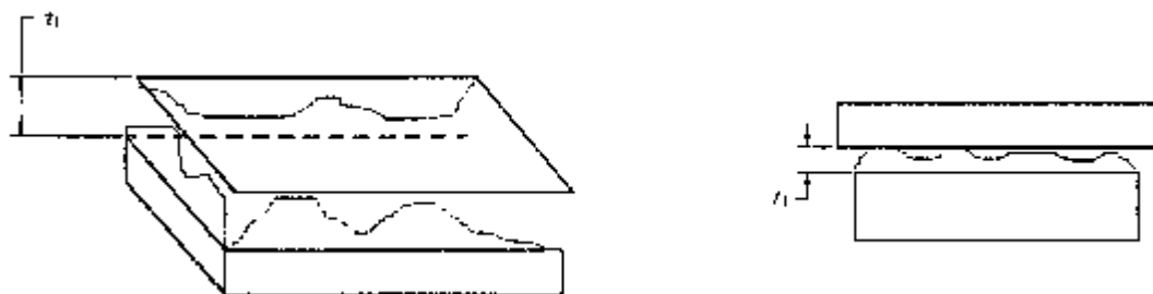
图 32 平面度的检验
