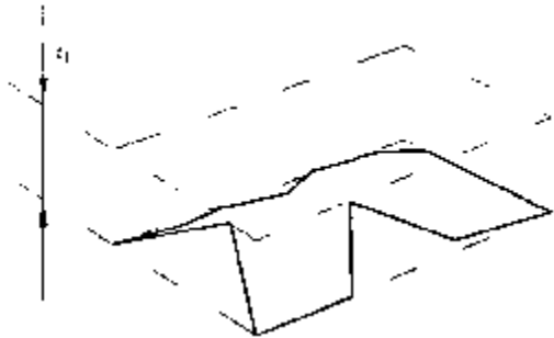
图 28 平面度公差值 t_1 图例
